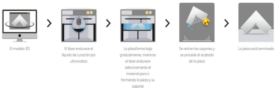
*Nota.* Se muestra el proceso y elementos requeridos para hacer efectivo la impresión 3D mediante la tecnología de estereolitografía.
